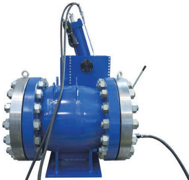
COLLAUDO IDRAULICO PER VALVOLE F600 PN100 (PRESSURE TEST = 150 BAR)
